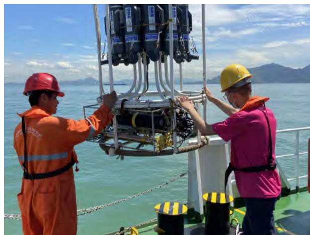
粵港澳大灣區夏季海洋綜合性科學考察隊成員將儀器放到海底，用來測試水質參數和採集水樣
